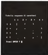
Figura 2 - Tabella della sequenza di due tasti. In verticale 1 e il tasto precedente, in orizzontale il tasto premuto. Le sequenze di due tasti producono il carattere risultante.
